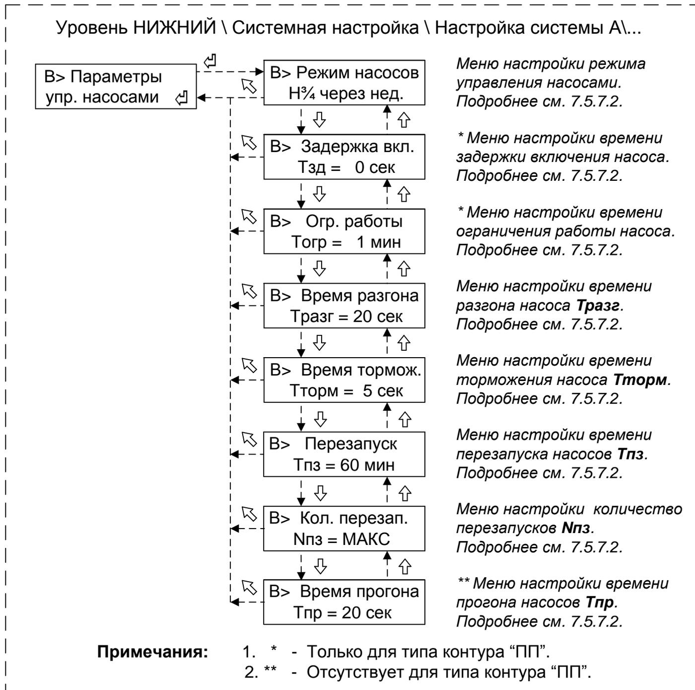
Рисунок 19 - Структура меню настройки параметров управления насосов
