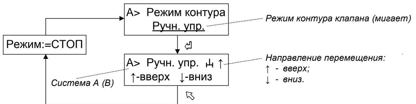
При нажатии и удержании кнопки “**▲**” или “**▼**” производится перемещение клапана в соответствующем направлении.
