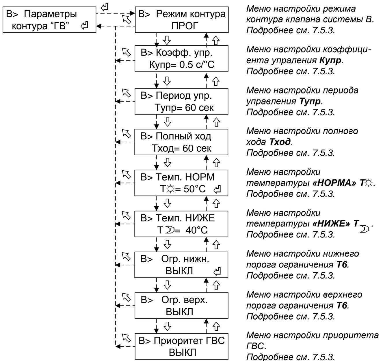
Рисунок 14 - Структура меню настройки параметров контура "ГВ"
