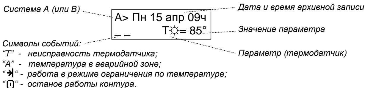
Перемещение по архиву производится при нажатии кнопок “▲” и “▼”, выход из просмотра архивных значений – при нажатии кнопки “↩”.
