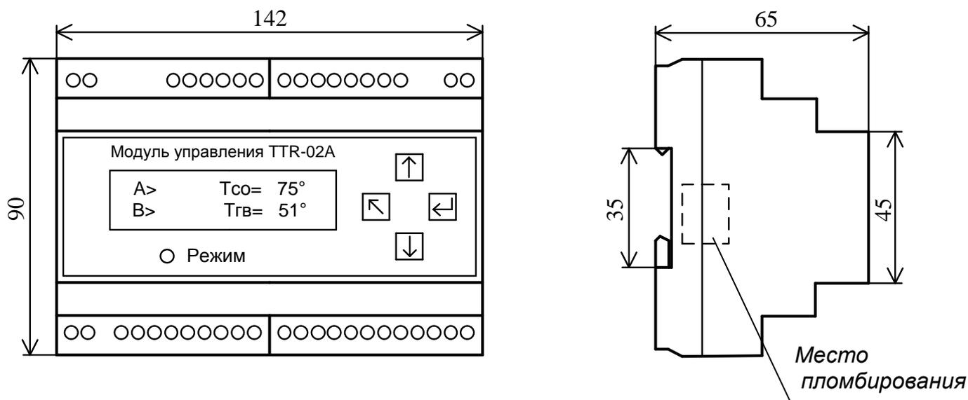
Рисунок Б.1 - Общий вид и габаритные размеры
