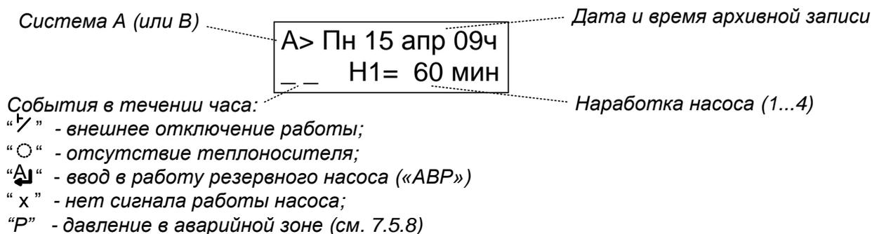
Переход по архиву производится по нажатию кнопок "▲" и "▼", выход из архива производится при нажатии кнопки "↶".
