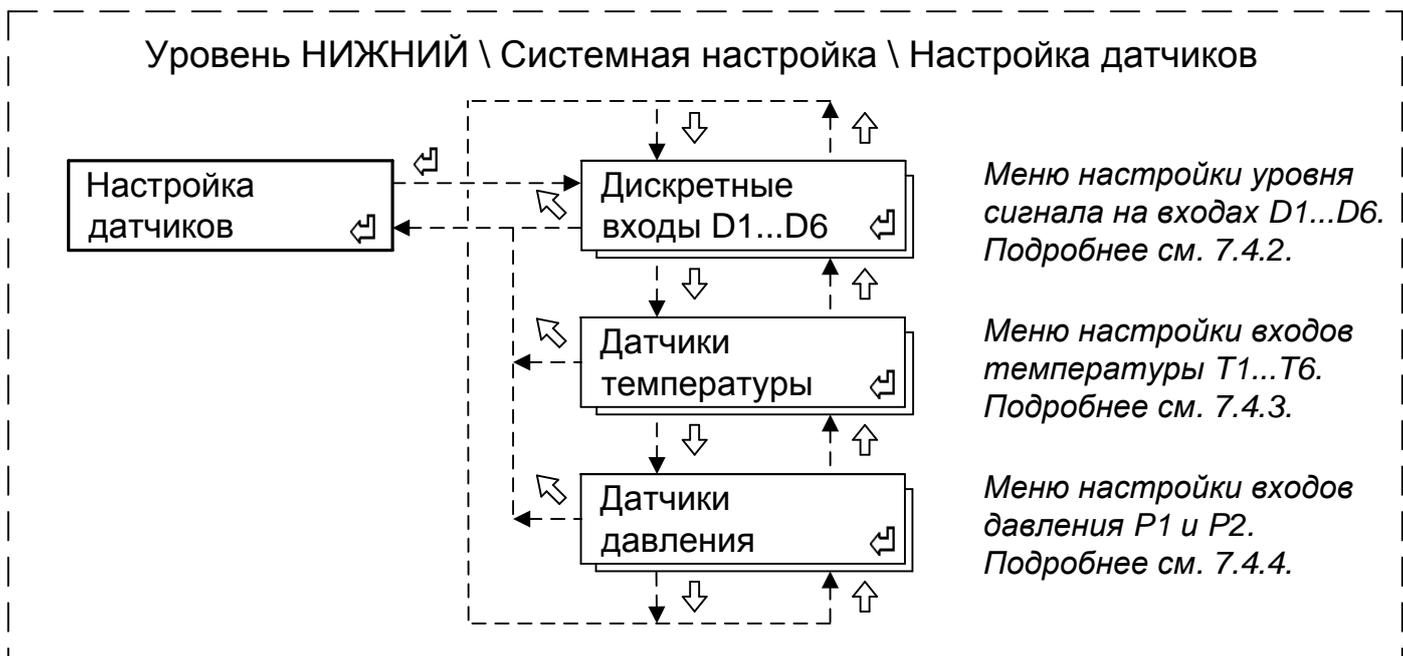
Рисунок 7 – Структура меню настройки датчиков (входов)
