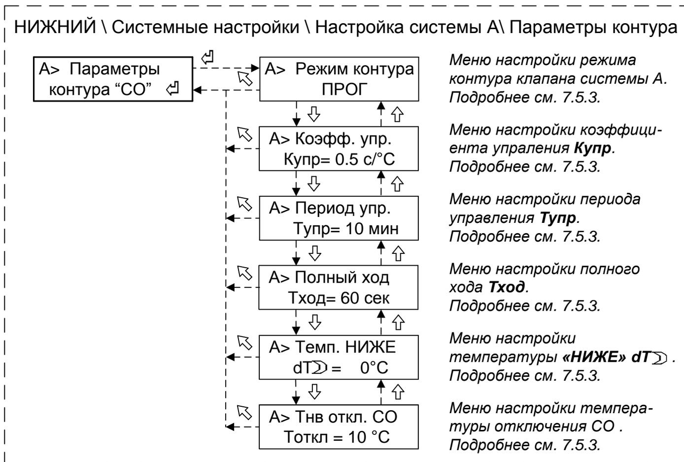
Рисунок 12 - Структура меню настройки параметров контура "СО"
