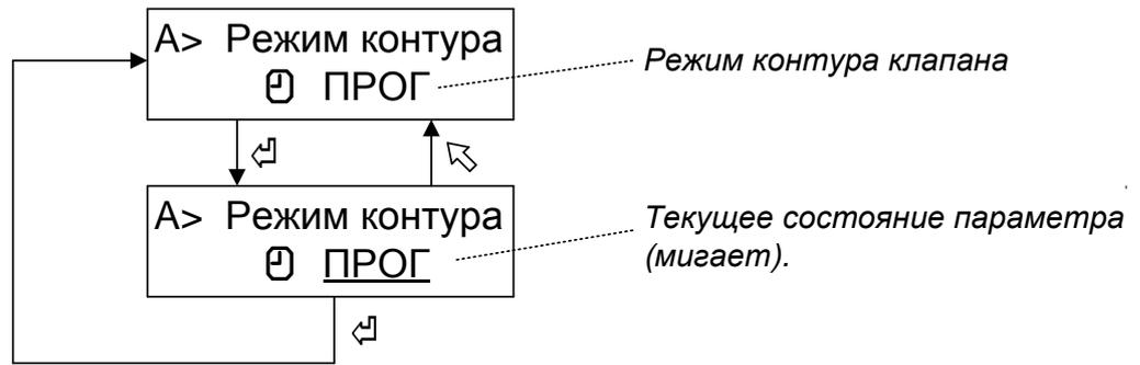
Изменение параметра (мигает) производится с помощью нажатия кнопок “**▲**” и “**▼**”.
