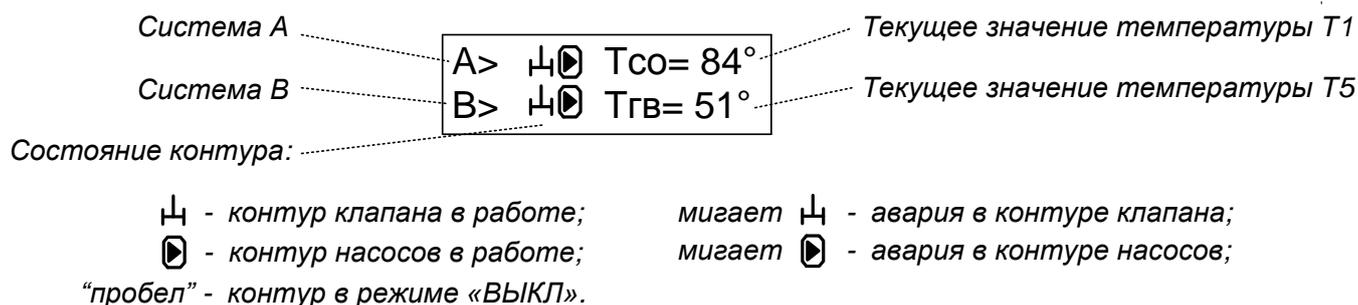
При наличии в конфигурации модуля управления ТТР контура “СО” по нажатию кнопки “↩” в течение 5 секунд выводится значение температуры наружного воздуха.
