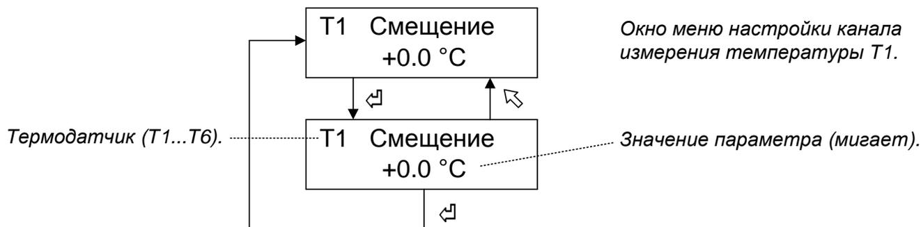
Изменение параметра (мигает) производится с помощью нажатия кнопок “▲” и “▼”. Диапазон изменения температуры от минус 9,9 °С до плюс 9,9 °С. Шаг изменения 0,1 °С.
