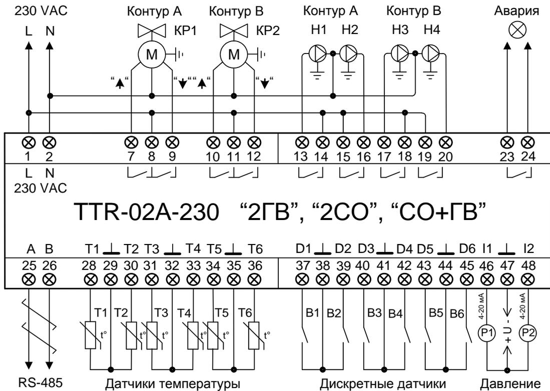
Рисунок В.3 – Схема подключений TTR-02A-230 для двухконтурной СО и ГВС
