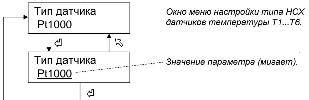
Изменение параметра (мигает) производится с помощью нажатия кнопок «↑» и «↓». Тип НСХ термодатчика может принимать значение Pt 500 или Pt 1000.
