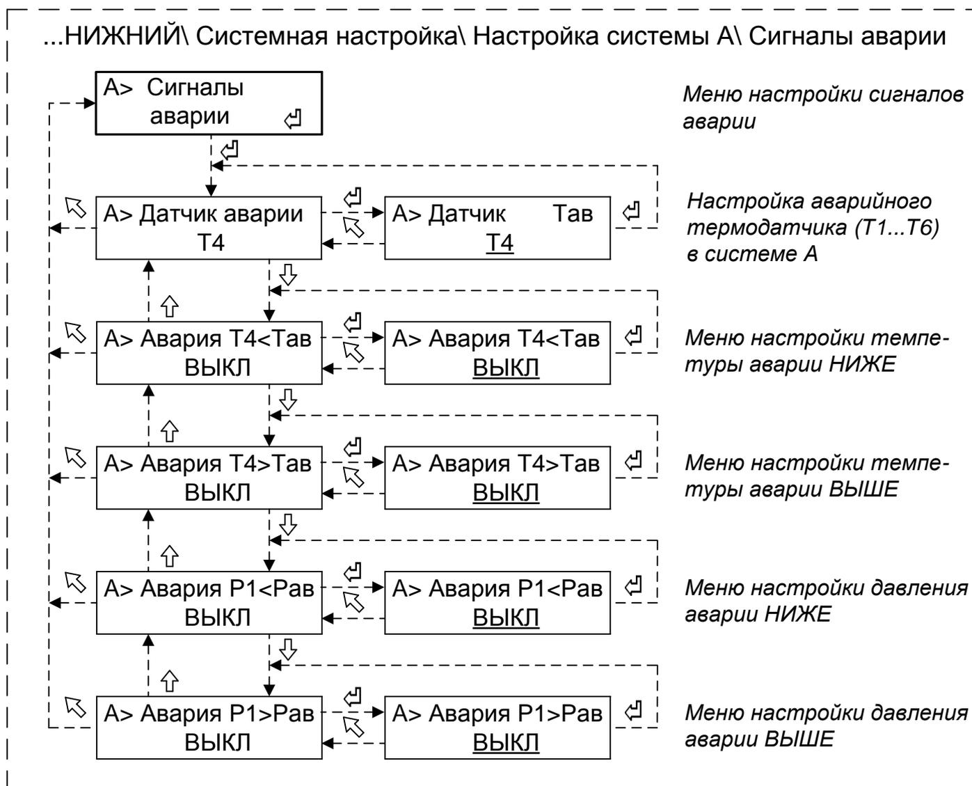
Изменение параметра (мигает) производится с помощью нажатия кнопок “**▲**” и “**▼**”.
