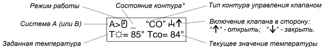
**Примечание \*** - символы состояния: “Т” - неисправность термодатчика;
