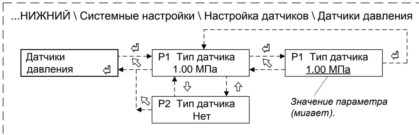
Рисунок 10 – Структура меню настройки датчиков давления
