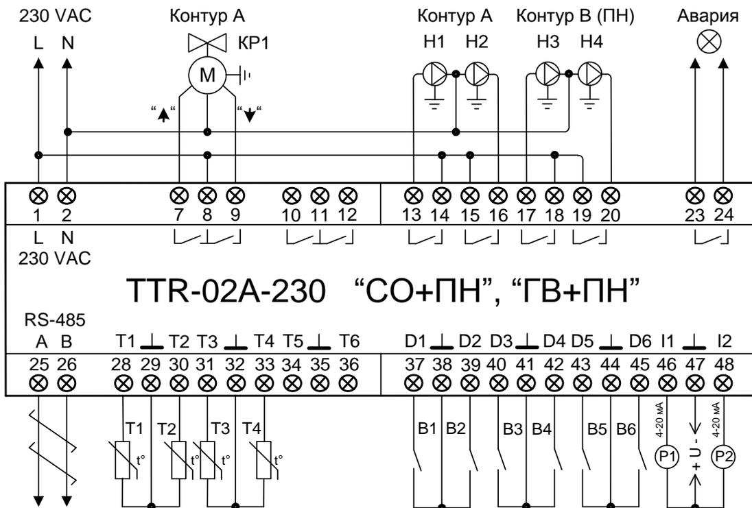
Рисунок В.4 – Схема подключений TTR-02A-230 для одноконтурной СО или ГВС с дополнительным контуром повысительных насосов (ПН)
