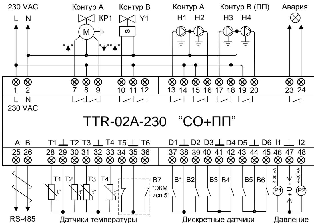
Рисунок В.6 – Схема подключений TTR-02A-230 для одноконтурной СО с узлом подпитки (ПП) при применении датчика давления В7 типа ЭКМ исп. 5 по ГОСТ 2405-88.
