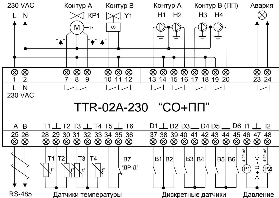
Рисунок В.5 – Схема подключений TTR-02A-230 для одноконтурной СО с узлом подпитки (ПП) при применении датчика-реле давления В7 типа “ДР-Д”.
