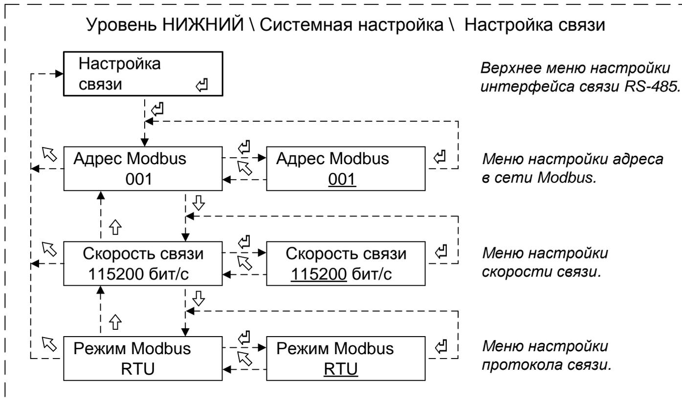
Рисунок 20 - Структура меню настройки сетевых параметров
