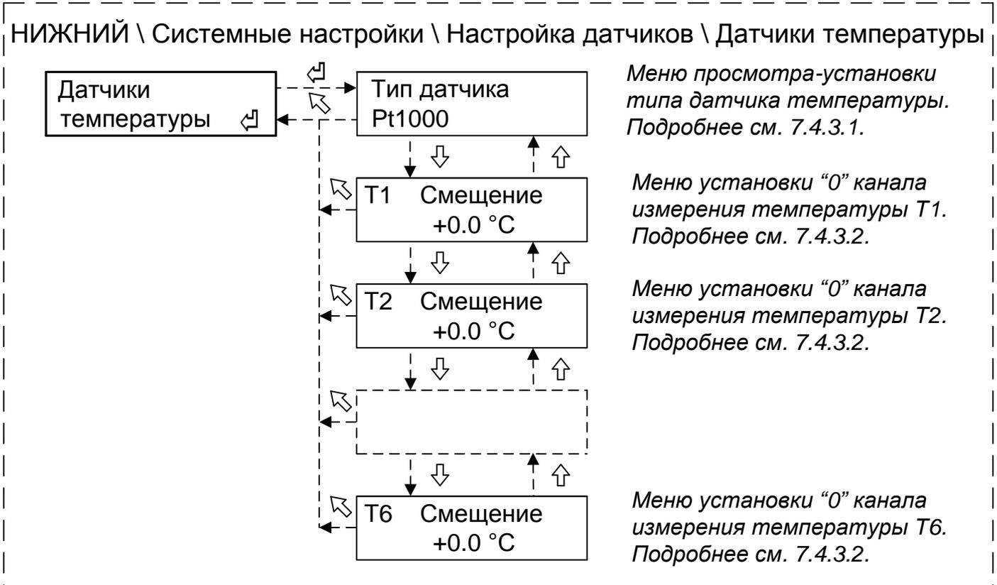
Рисунок 9 – Структура меню настройки датчиков температуры
