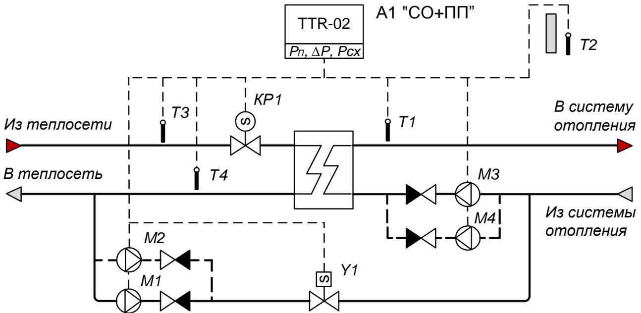
**Пример применения:** Модуль управления А1 поддерживает в системе отопления температурный график теплоносителя  $T1=f(T2)$ . При измерении температуры Т4 обеспечивает ограничение температуры теплоносителя, возвращаемого в систему теплоснабжения. Доступна функция понижения температуры теплоносителя по временному графику.
