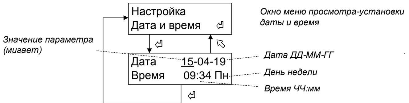
Изменение значения параметра производится с помощью нажатия кнопок “▲” и “▼”.
