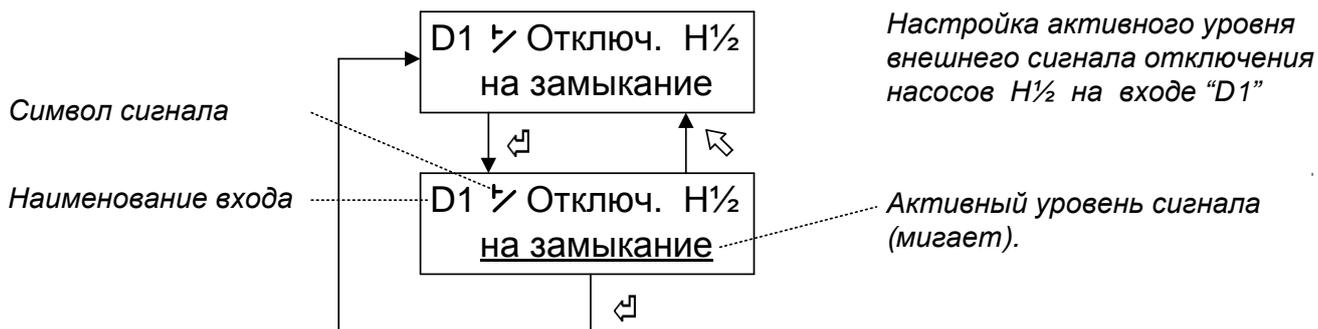
Изменение активного уровня производится с помощью нажатия кнопок “↑” и “↓”.
